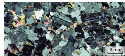
B Granite sain observé au microscope en lumière polarisée analysée (LPA*).
