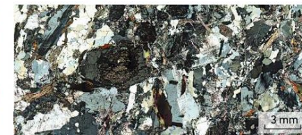
C Granite altéré observé au microscope en lumière polarisée analysée (LPA).
